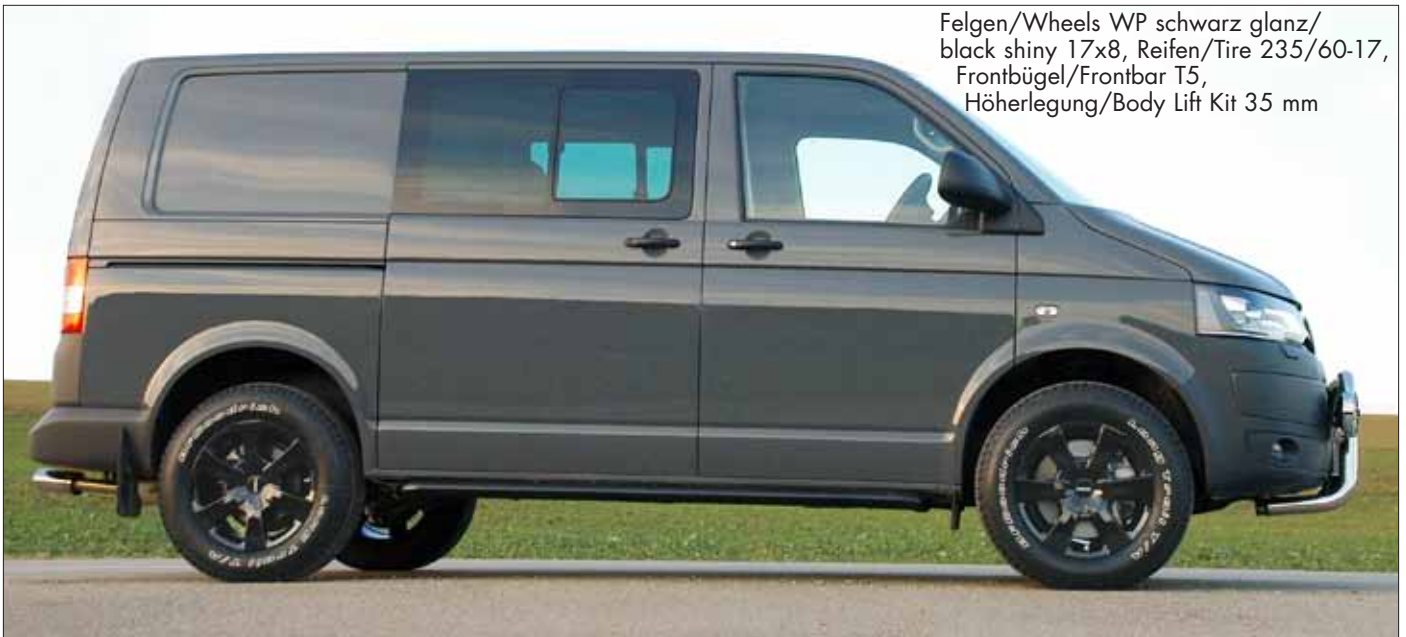
Felgen/Wheels WP schwarz glanz/black shiny 17x8 Reifen/Tire 235/60-17, Frontbügel/Frontbar T5, Höherlegung/Body Lift Kit 35 mm
