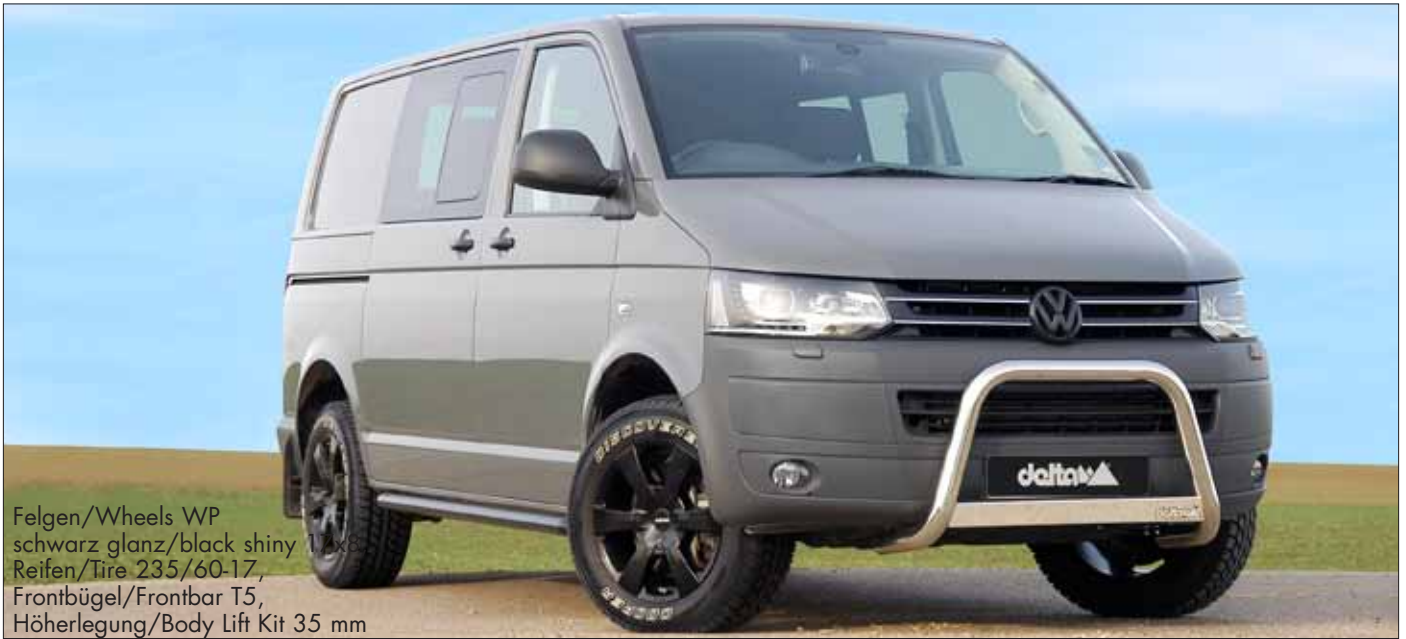
Felgen/Wheels WP schwarz glanz/ black shiny 17x8, Reifen/Tire 235/60-17, Frontbügel/Frontbar T5, Höherlegung/Body Lift Kit 35 mm
