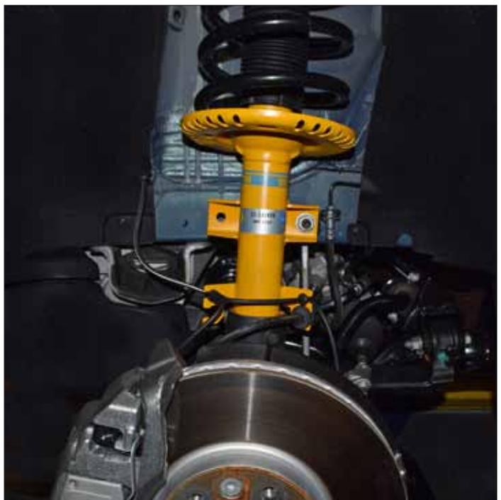
Fahrzeughöherlegung, Federdistanz-Satz mit Bilstein Stoßdämpfersatz +25 mm,
