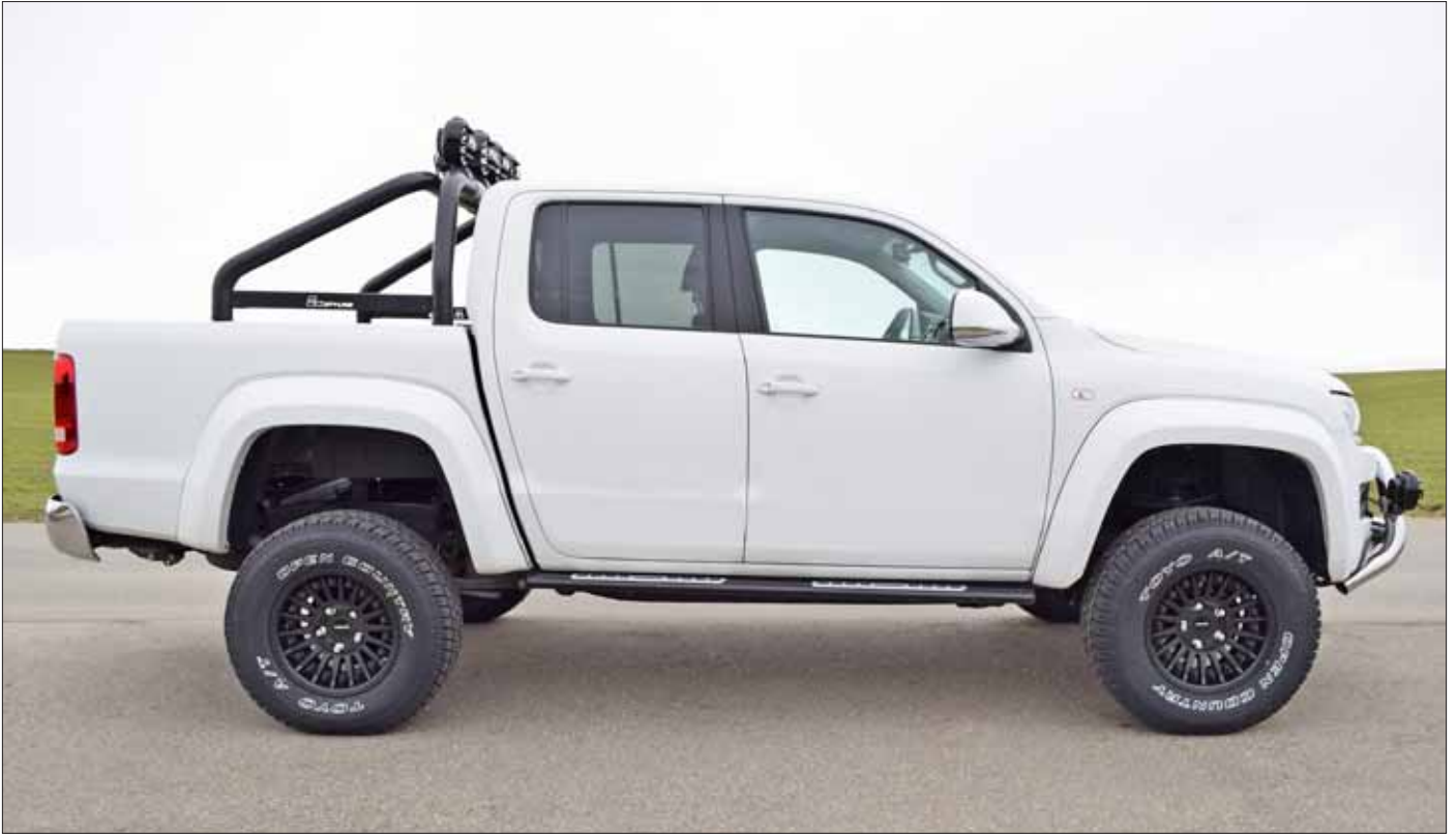
Felgen/Wheels Hutch2 black matt 17x8,5 Zoll, Reifen/Tire Toyo 285/70-17 mit Teilegutachten/homologation for Germany, Frontbügel handpoliert 76 mm/Front bar handpolished approved after EC pedestrian security law 76 mm, Höherlegungssatz/Body lift kit 100 und 40 mm, Seitentrittbretter schwarz/Side steps black, Radhausverbreiterung/Fender flares, Edelstahl Sportbügel schwarz handpoliert 76 mm/ Sports bar black Stainless steel handpolished 76 mm
