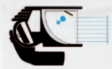
LED-Licht wird von Reflektoren gebündelt. Dadurch mehr gezielte Ausleuchtung bei weniger Energie.
