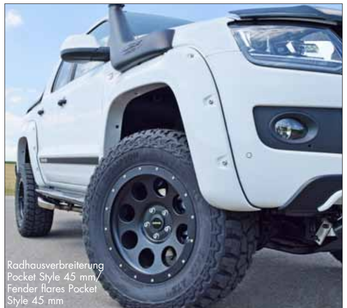
Felgen/Wheels Klassik_B black matt 18x9 Zoll, Reifen/Tire MickeyThompson ATZ 305/60-18 Frontbügel schwarz handpoliert 76 mm/Front bar black handpolished approved after EC pedestrian security law 76 mm, PIAA 520 Rallye Lights, Höherlegungssatz/Body lift kit 100 mm, Radhausverbreiterung Pocket Style 45 mm/Fender flares Pocket Style 45 mm
