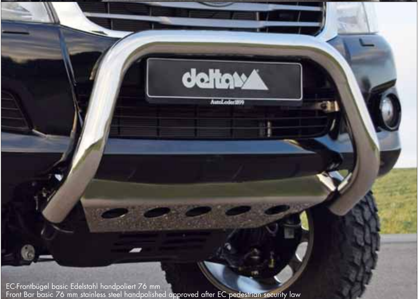
EC-Frontbügel basic schwarz Edelstahl 76 mm Front bar basic black stainless steel 76 mm approved after EC pedestrian security law Fernscheinwerfer PIAA RF6/PIAA Light Bar RF6, Halterung für Frontbügel/Brackets for Front Bar
