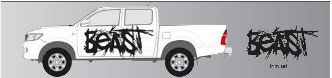
Felgen/Wheels Klassik_B black 18x9, Reifen Mickey Thompson STZ 265/60-18 Höherlegung/Body Lift Kit 100 mm, Höherlegung/Suspension Distance Kit 40 mm
