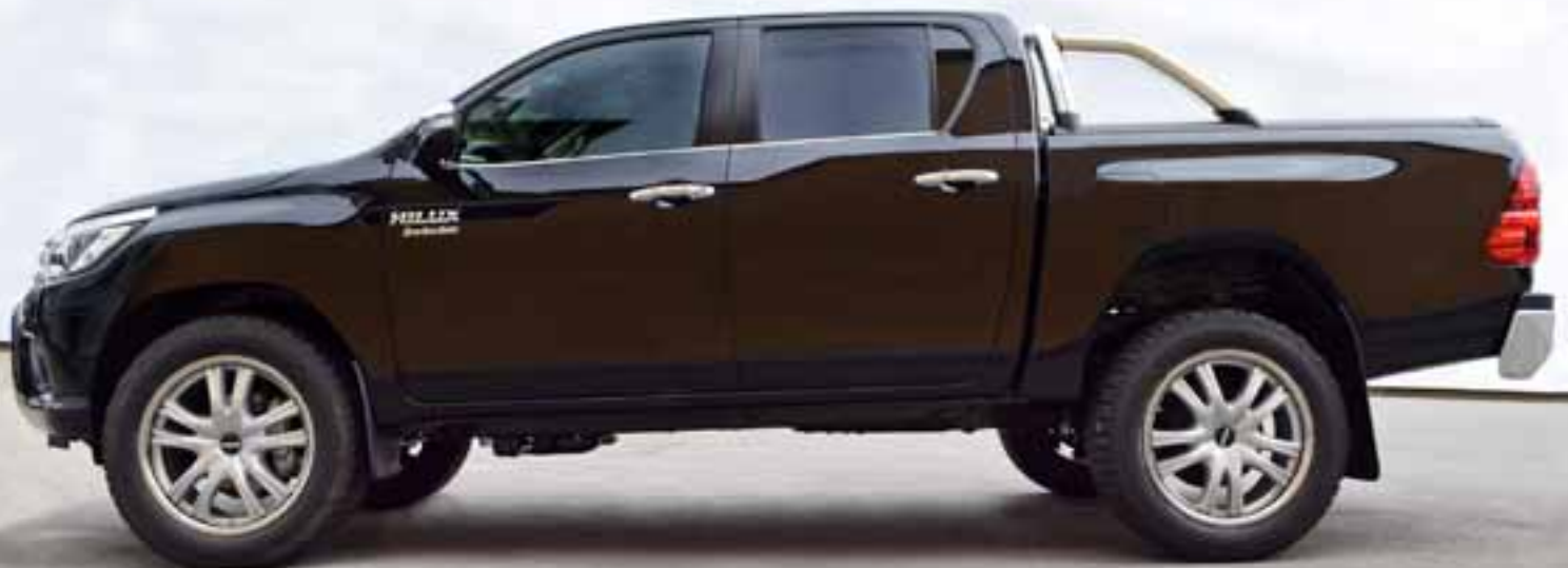
Felgen/Wheels Lander 20x9 silber/silver Edelstahl Sportbügel 76 mm handpoliert/Sports bar stainless steel 76 mm handpolished Höherlegung/Body Lift Kit 100 mm, Höherlegung/Suspension Distance Kit 40 mm
