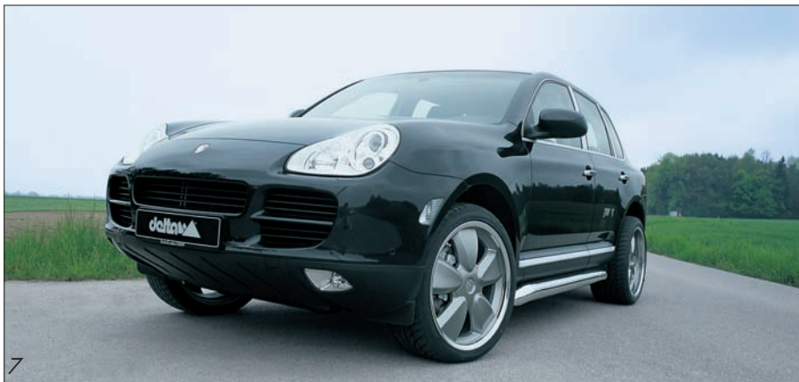
Räder/Wheels delta Hollow: Vorne/front 9,5x21, Reifen/tire 275/35-21 Hinten/rear 11x21, Reifen/tire 325/30-21 Seitenbügel/Side steps delta basic 101 mm
