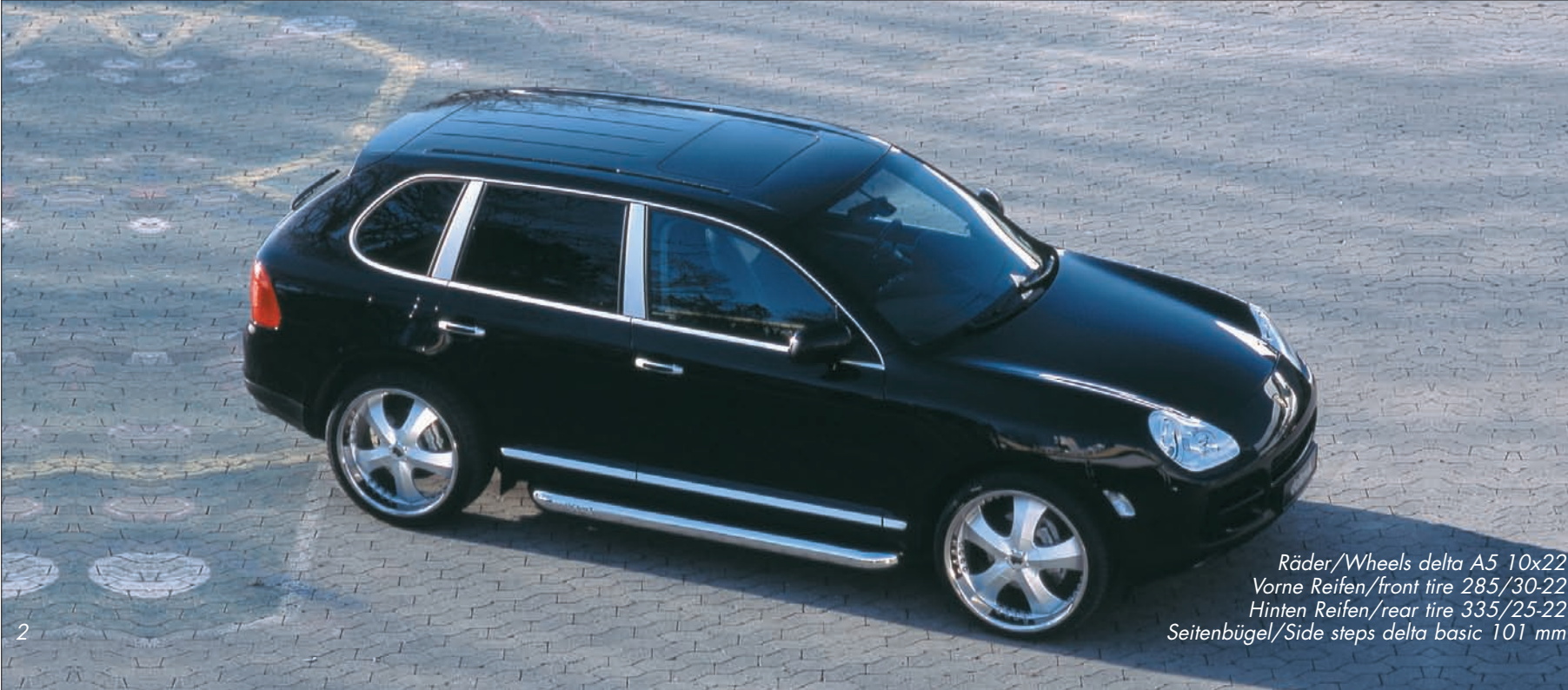
Räder/Wheels delta A4 10x22 mit Reifen/with tires 285/30-22 Seitenbügel/Side steps delta basic 101 mm
