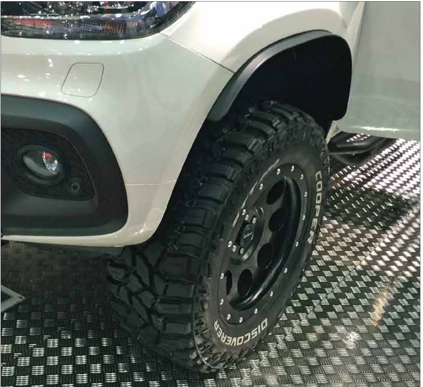
Verbreiterungslippen ca. 30 mm/Lip smal fender extensions ca. 30 mm
