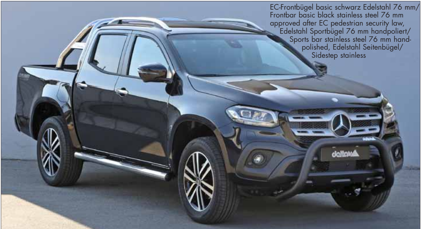
Felgen/Wheels Klassik_B matt schwarz/black 18x8,5, Reifen/Tire BF Goodrich Größe 265/65-18 Höherlegung/Suspension Distance Kit 40mm
