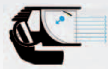
LED-Licht wird von Reflektoren gebündelt. Dadurch mehr gezielte Ausleuchtung bei weniger Energie.
