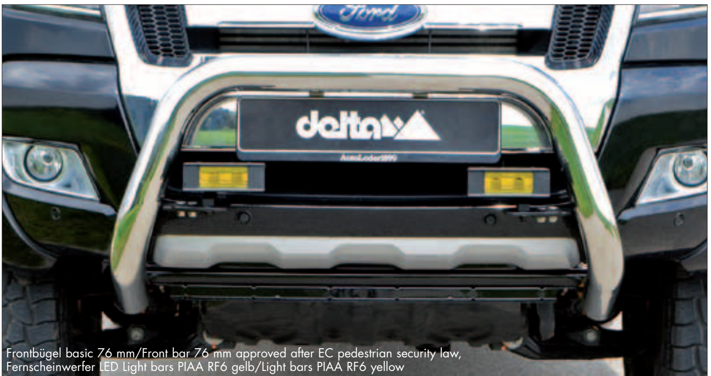
Felgen/Wheels Lander Pure matt schwarz/black 22x9, Reifen/Tires Toyo Open Country 325/50-22 Frontbügel basic 76 mm/Front bar 76 mm approved after EC pedestrian security law, Radhausverbreiterung ca. 70 mm/Fender flares delta wide body ca. 70 mm, Edelstahl Doppelrohrbügel 76 mm handpoliert/Double sports bar stainless 76 mm hand polished Höherlegung OME-Fahrwerk +50 mm Fernscheinwerfer LED Light bars PIAA RF6 und RF18 gelb/Light bars PIAA RF6 and RF18 yellow
